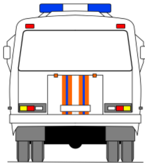
Рисунок А.31 — Цветографические схемы автомобилей служб предотвращения и помощи при чрезвычайных ситуациях и гражданской обороны
