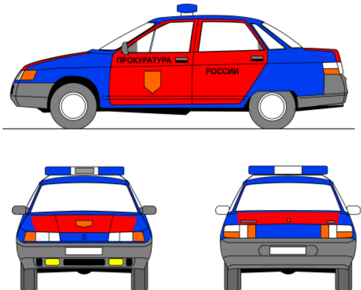
Рисунок А.42 — Цветографические схемы автомобилей служб прокуратуры
