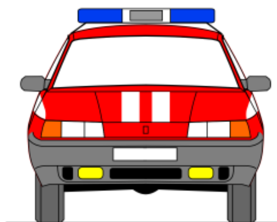
Рисунок А.3 — Цветографические схемы автомобилей противопожарной службы
