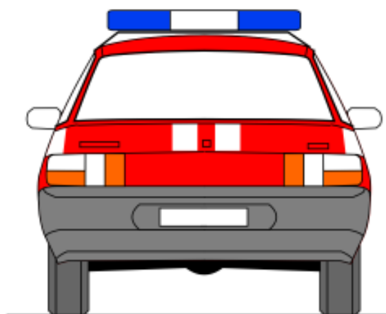
Рисунок А.3 — Цветографические схемы автомобилей противопожарной службы
